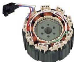
Бекolleкторный синхронный электродвигатель компрессора
