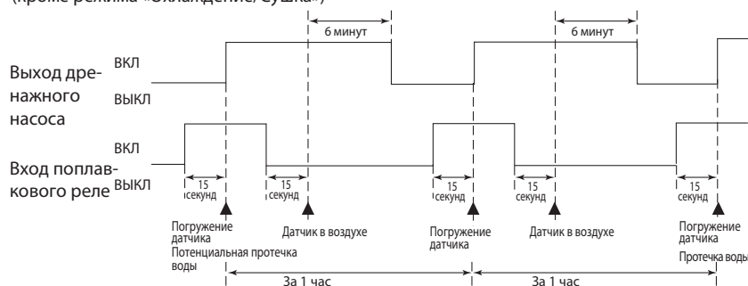
Схема работы дренажного насоса, вызванная подтоплением жидкоуровневого датчика (кроме режима «Охлаждение/Сушка»)
