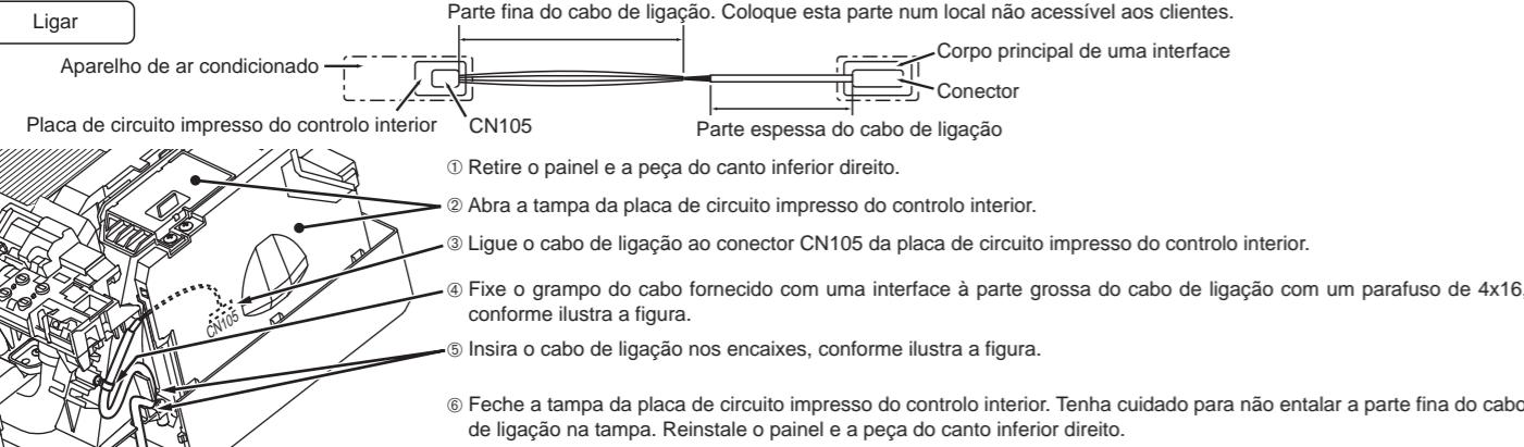
**AVISO** Fixe o cabo de ligação firmemente na posição recomendada. Uma instalação incorrecta pode provocar choque eléctrico, incêndio e/ou mau funcionamento.
