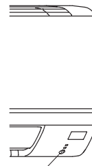
Переключатель аварийного управления (E.O. SW)
